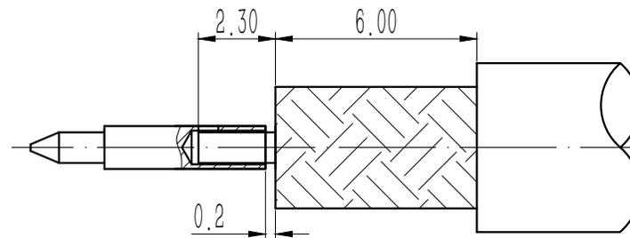
建议剥线焊接尺寸
